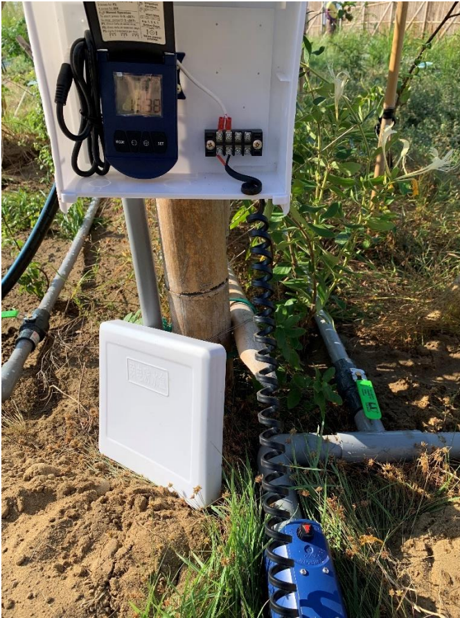
圖 4.8、為節省半天寮草本培育苗圃用水，精準管控植栽的給水時間與水量，9 月份設置計時裝置與自動啟閉水閥，亦減少人工澆水的時間投入。
