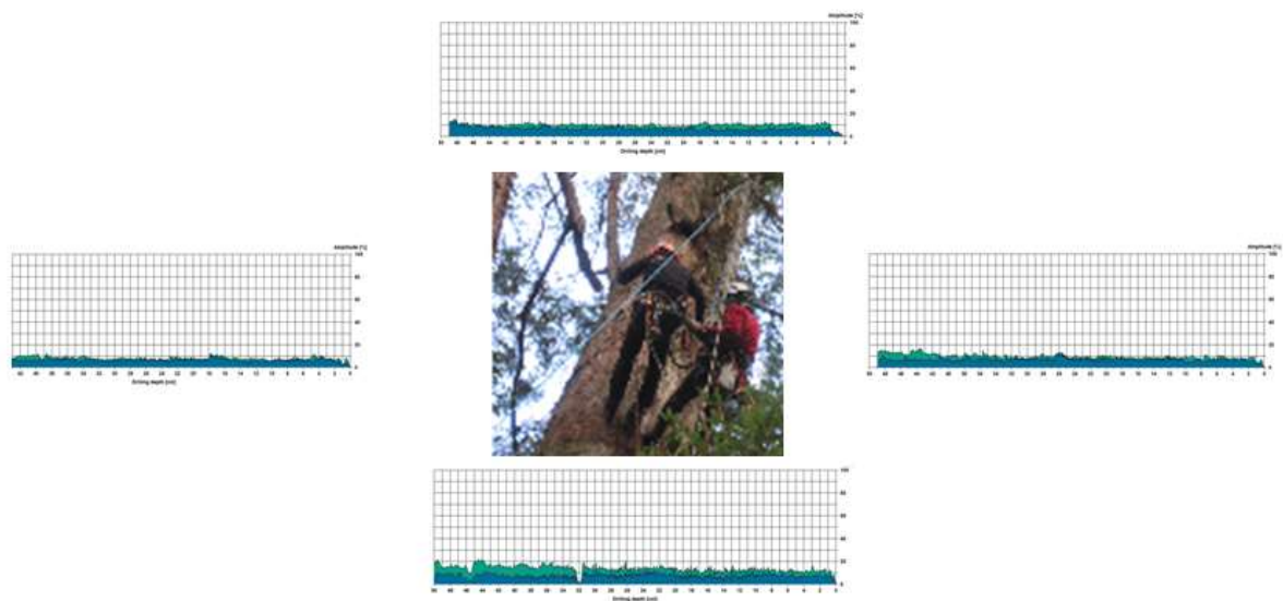
圖 27.5 號巨木低點目標高度阻抗試驗結果
