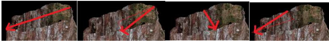
圖 11.2 號巨木打音試驗依槌擊方向與收音分為 4 種方向
