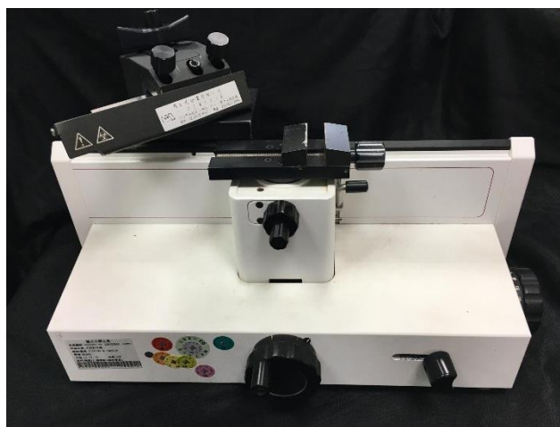
圖 2、滑動式切片機 (Sliding microtome, MH400R) 之外觀。
