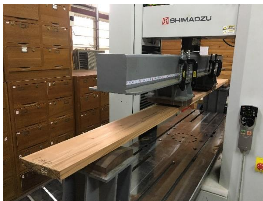
圖 70、依照中華民國國家標準總號 CNS 14630 針葉樹結構用製材標準，進行製材品機械等
