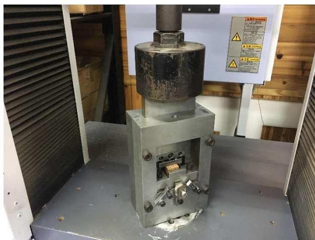
圖 6、木材抗剪試驗之配置。
