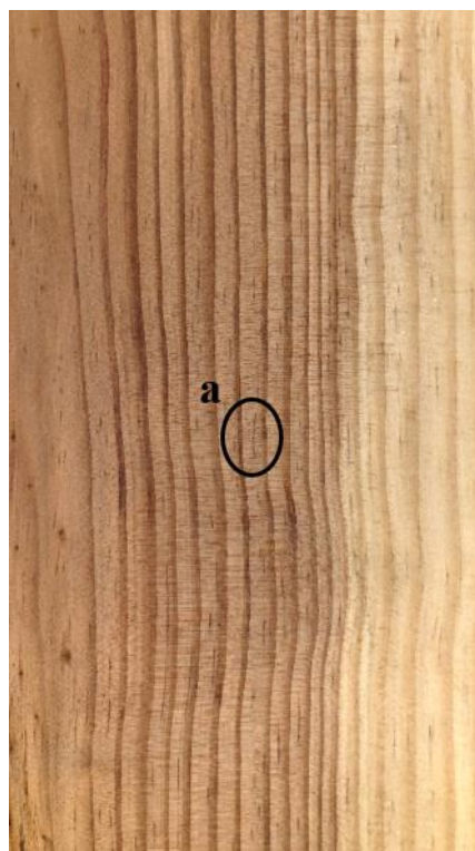
圖 10、臺灣二葉松徑切面之材面照片。(a) 樹脂溝紋路。
