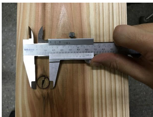
圖 69、依照中華民國國家標準總號 CNS 14630 針葉樹結構用製材標準，進行製材品目視等級區分之節徑量測。
