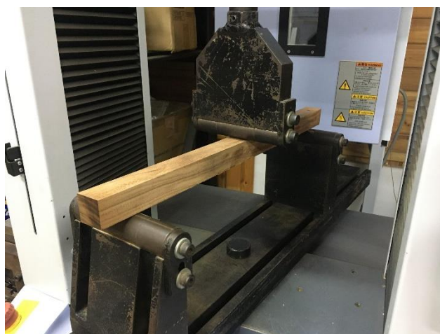
圖 4、木材抗彎試驗之配置。
