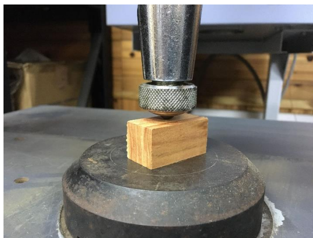
圖 7、木材勃氏硬度試驗之配置。
